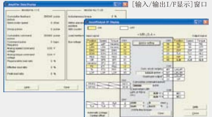
更新了[输入/输出I/F显示]窗口。能够同时打开[输入/输出I/F显示]窗口和[放大器数据显示]窗口，因此能够实时检查DI/DO的ON/OFF状态和运行状态。
