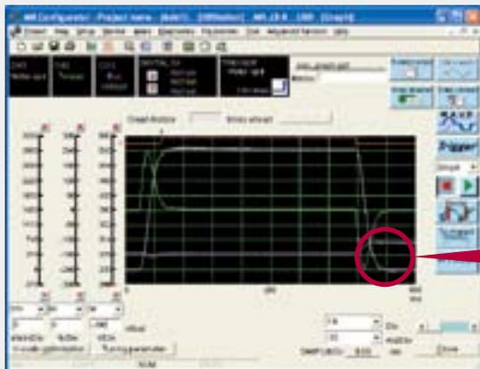
有3个模拟量通道和4个数字量通道的强大的图形功能支持调谐。提供便于使用的功能，例如[覆盖]功能，[图形历史]功能和强大的多波形选择功能。其他功能包括[灰度显示]功能(易于读取打印数据)以及以CSV格式或JPEG格式保存数据。
